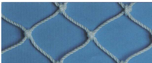
Actual size mesh — 200 lb test twine
